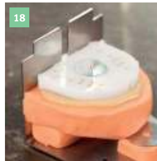
18 Overtollige gips langs de sokkelplaat na licht aantrekken voorzichtig verwijderen.
