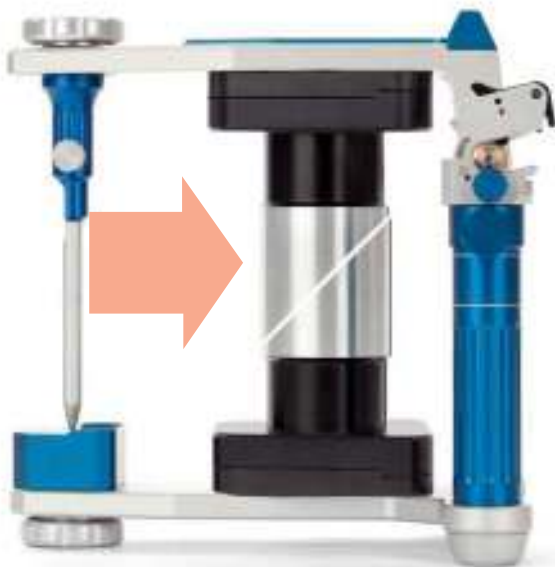
Foutieve articulator: duidelijk zichtbare spleet
