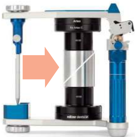
Foutieve articulator: duidelijk zichtbare spleet
