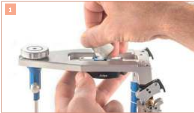
1 ADESSOSPLIT® sokkelplaat in het bovenste gedeelte van de CORSOART® articulator vastschroeven.
