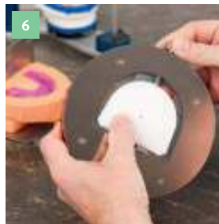
6 De sokkelplaat in de boorplaathouder van het pinboorapparaat zetten.
