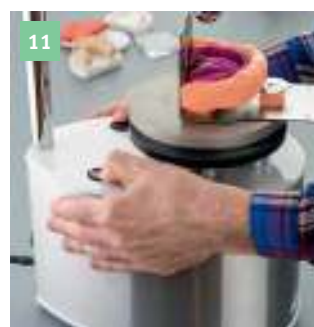
11 De knop indrukken om te beginnen met boren, de boorplaathouder wordt elektromagnetisch gefixeerd.
