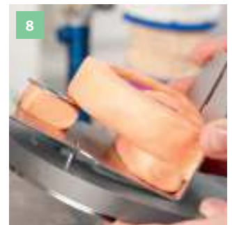
8 De afdrukhouder op de boorplaathouder zetten.
