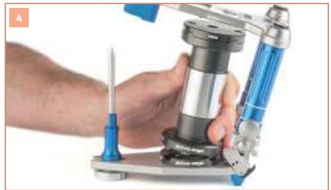
4 Vóór het lijmen de articulator sluiten. De verlijmbare onderplaat moet een lijmspleet van 1-2 mm tot het bovenste gedeelte van de articulator bezitten en de incisaalstift moet de incisaaltafel raken.
