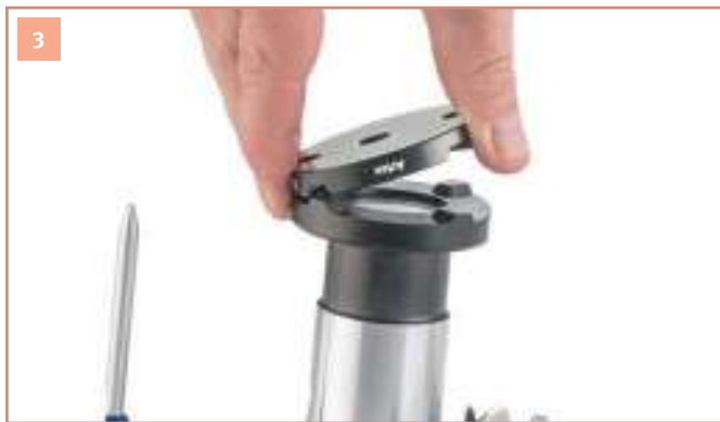
3 Verlijmbare onderplaat op reinheid controleren en op de ADESSOSPLIT® ijsleutel plaatsen.
